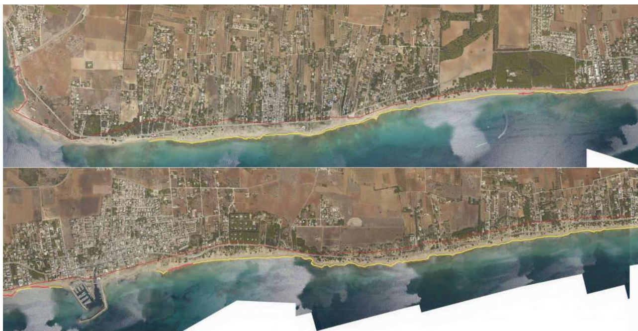
Imm. 53: Individuazione tratti di costa ad Alta (in rosso) e Media Criticità (in giallo) su Ortofoto 2017 - Elaborazione su dati PRC (shapefile dettaglio_criticita.shp).
