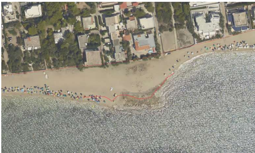
Imm. 3 Linea di riva anno 2005 (tratto ad Alta Criticità ad ovest di Campomarino) su Ortofoto 2017. La spiaggia sabbiosa appare in avanzamento.
